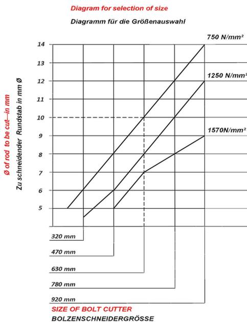
Mit auswechselbaren Dreikantschneiden aus Spezialstahl geschmiedet. Schneiden aus Sonderstahl. Pulver beschichtete Rohrschenkel, geeignet für Baustähle bis 12 mm Durchmesser (1570 N/mm<sup>2</sup>) oder Federstahl bis 10 mm Durchmesser (1760 N/mm<sup>2</sup>).
