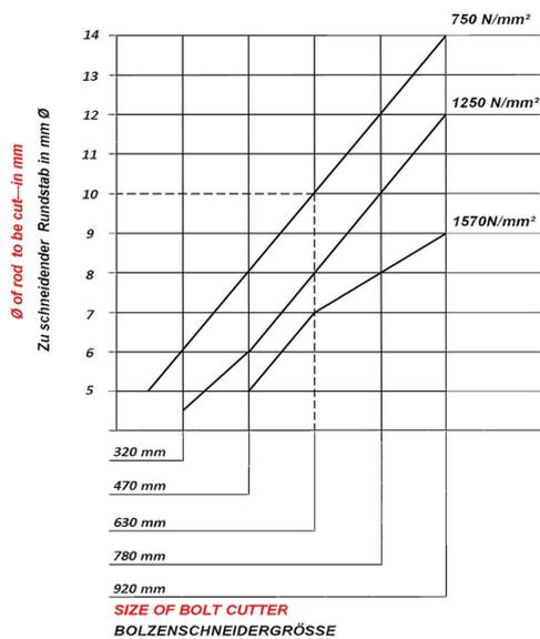
Für handelsüblichen Betonstahl III + VI nach DIN 488 Festigkeit ca. 550 N/mm<sup>2</sup> sowie Spannstähle und vergüteten Stahldraht bis zu einer Festigkeit von 1570 N/mm<sup>2</sup> (48 HRC) ; Spezialstahl geschmiedet, Schneiden hochfrequenzgehärtet, pulverbeschichtete Rohrschenkel, geeignet für Baustähle bis 1570 N/mm<sup>2</sup> Festigkeit.
