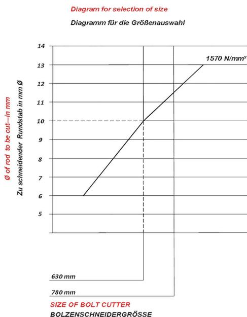
Für handelsüblichen Betonstahl III + VI nach DIN 488 Festigkeit ca. 550 N/mm<sup>2</sup> sowie Spannstähle und vergüteten Stahldraht bis zu einer Festigkeit von 1570 N/mm<sup>2</sup> (48 HRC). Mit auswechselbaren Dreikantschneiden, aus Spezialstahl geschmiedet, Schneiden aus Sonderstahl, pulverbeschichtete Rohrschenkel, geeignet für Baustähle bis 12 mm ∅ (1570 N/mm<sup>2</sup>) oder Federstahl bis 10 mm ∅ (1760 N/mm<sup>2</sup>).
